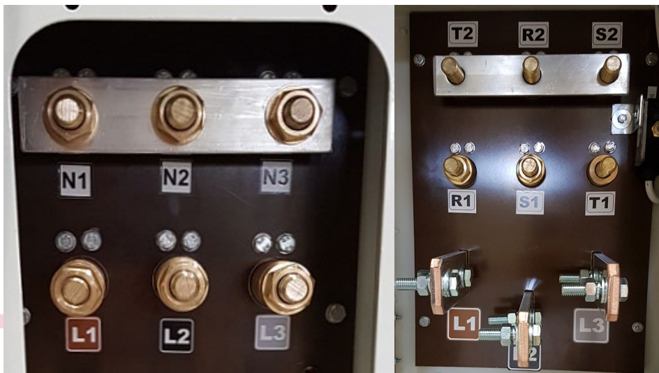
Abbildung 15 – Stern/Dreieck, manuelle Konfiguration
