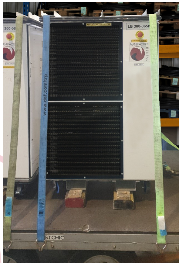
Abbildung 7 – Niederzurren einer Lastbank mit Rollen
