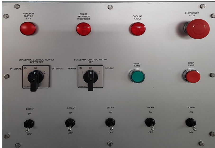
Abbildung 21 – Armaturentafel mit Umschaltern, Wählschaltern und Druckknöpfen
